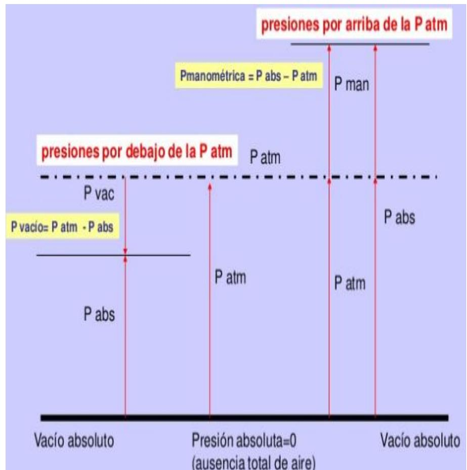
Consecuentemente, la presión absoluta es la presión atmosférica ( $P_a$ ) más la presión manométrica ( $P_m$ ) (presión que se mide con el manómetro).
