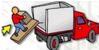
Un plano inclinado consta simplemente de una rampa, es decir, una superficie plana con un ángulo mucho menor de 90° respecto al suelo o eje horizontal. Se utiliza cuando es necesario subir cajas, muebles, animales, barriles u otros cuerpos a un camión de carga o a cierta altura de una construcción. Para analizar las fuerzas existentes sobre un cuerpo situado sobre un plano inclinado, hay que tener en cuenta la existencia de varios orígenes en las mismas.
